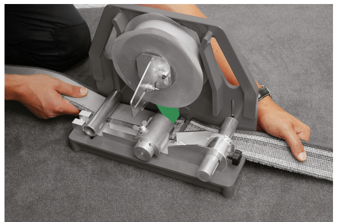
5. Tirer la bande de moquette avec le ruban jusqu'à ce que la bande de moquette ou le ruban soit terminé. Introduire ensuite une nouvelle bande de moquette ou un nouveau ruban comme décrit aux points 1 et 2.
