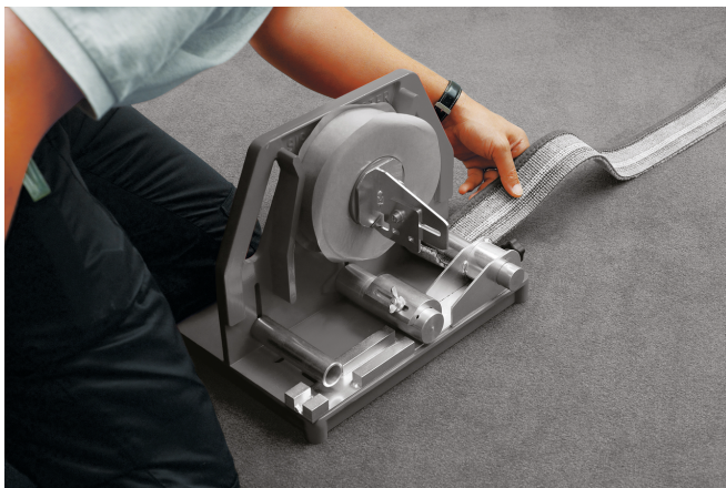
2. Introduire la bande de moquette dans le guide.
